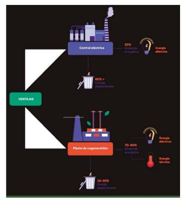
Figura 2. Cogeneración de alta eficiencia
