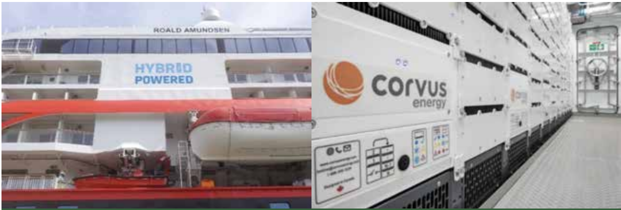
Figuras 5 y 6. Hybrid Powered. Izquierda: en ambos laterales del buque MS Roald Amundsen hay ostensibles leyendas que informan acerca del tipo de propulsión implementada. Derecha: vista de las baterías marinas ubicadas en la sala de máquinas y que típicamente se operan en modo recorte de picos ( Peak Shaving ).
