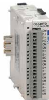
Figura 2. Una tarjeta/módulo de un PLC con cuatro canales de entrada para RTD
